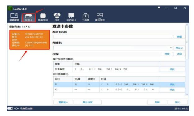
注意: LedSet4.0 检测不到发送卡,请关闭防火墙等杀毒软件。
