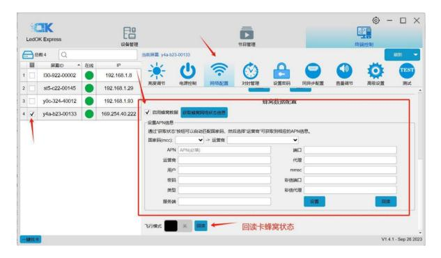
设置好 3G/4G 参数后,等待 5 分钟左右控制卡自动拔号 3G/4G 网络入网; 观察控制卡的 "internet" 灯匀速慢闪,即表示已接入云平台,此时即可登录云平台 www.m2mled.net 发送 节目。
