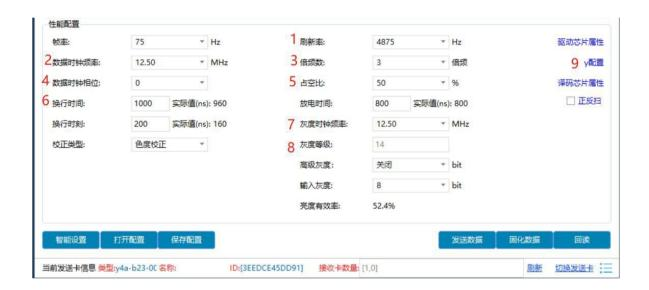
(9) **γ配置**: Gamma 调节,Gamma 表示原始信号的度量参数,是指显示器的输出图像对输入信号的失真,Gamma 值指这种失真的具体数值。在 Gamma 设置栏目上调节所需 Gamma,默认值为 2.8,也可使用自定义 Gamma 值进行编辑或者加载外部 Gamma 表。调试完后点击发送,将调节效果保存到接收卡。
