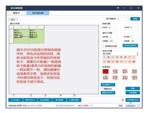
(1) **切换发送卡**:在同时接入多张发送卡时,可点击切换发送卡,进入发送卡切换界面。类型,名称,ID 是为了区分发送卡,"名称"可以在发送卡界面中编辑。即发送卡连接的接收卡数量,两个数值分别代表发送卡两个口所带载的接收卡,如:接收卡数量:[1.0]表示发送卡 1 口带载 1 张接收卡,2 口带载 0 张接收卡。
