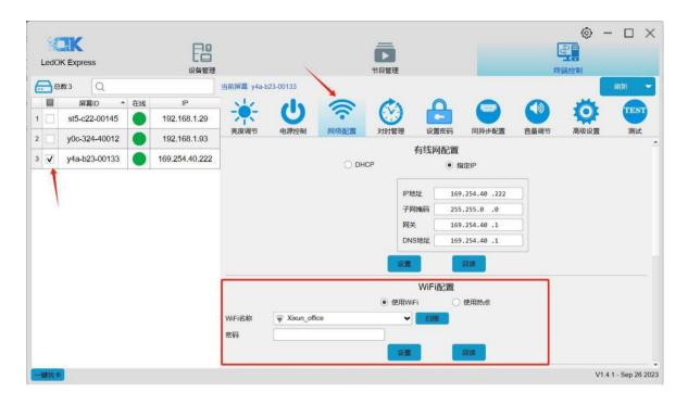
约 3 分钟左右,控制卡自动搜索连接配置的 WiFi 热点,控制卡上的 "internet" 灯匀速慢闪,表示已接入云平台,此时即可登录云平台 www.m2mled.net 发送节目。
