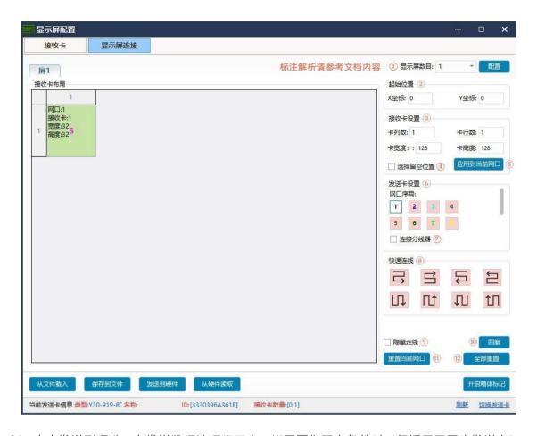
21. 点击发送到硬件,在发送数据选项窗口中,当需要做双卡备份时(仅适用于同步发送卡), 主卡发送时直接选择"作为主发送卡"并保存到设备。点击"切换发送卡",切换到备份卡再 发送,此时选择"作为备份发送卡"发送并保存到设备。
