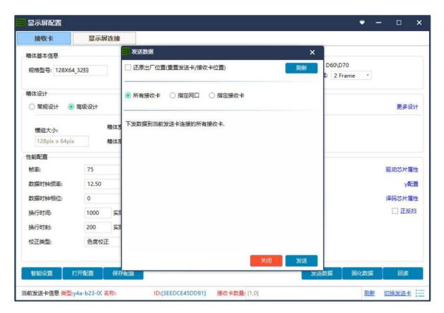
17. 观察箱体是否正常显示,满意后点击固化数据,将数据固化到接收卡,防止在接收卡断电重 启 后数据丢失。
