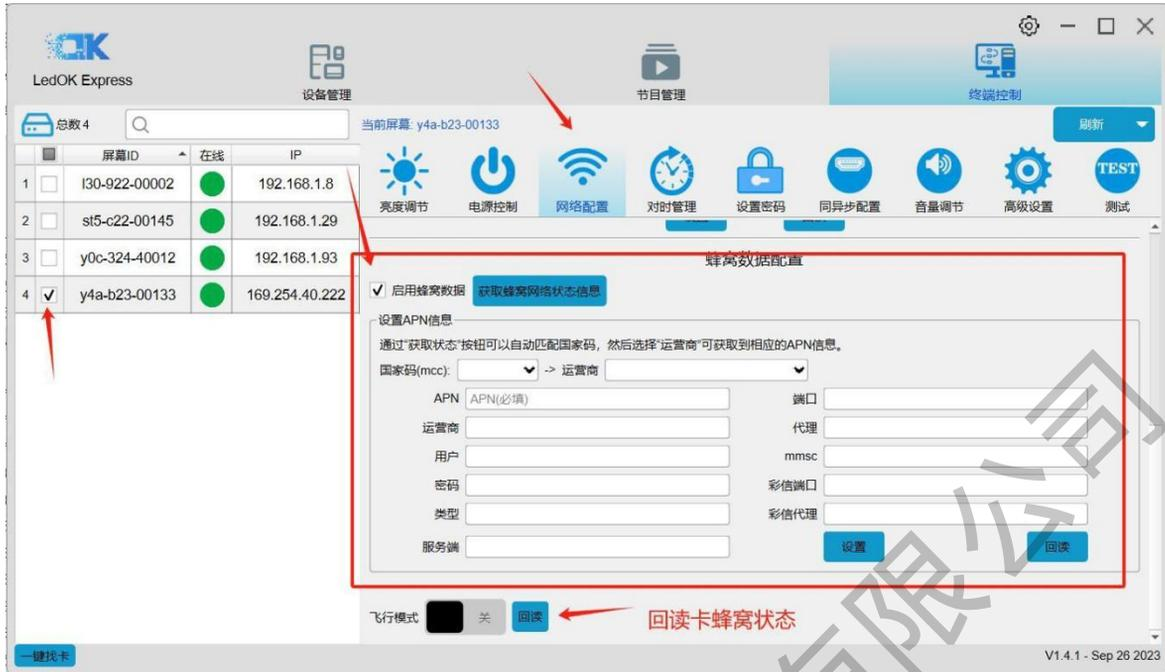
设置好 3G/4G 参数后，等待 5 分钟左右控制卡自动拨号 3G/4G 网络入网；观察控制卡的“internet”灯匀速慢闪，即表示已接入云平台，此时即可登录云平台 [www.m2mled.net](http://www.m2mled.net) 发送节目。
