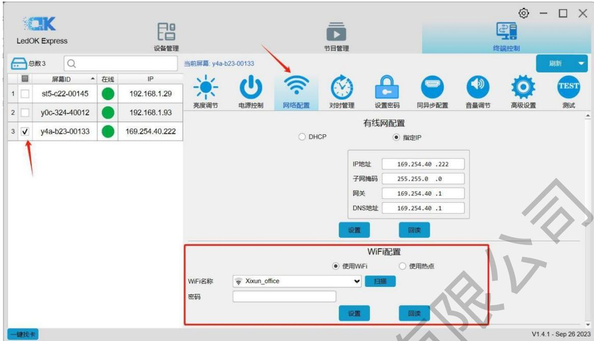
约 3 分钟左右，控制卡自动搜索连接配置的 WiFi 热点，控制卡上的“internet”灯匀速慢闪，表示已接入云平台，此时即可登录云平台 [www.m2mled.net](http://www.m2mled.net) 发送节目。
