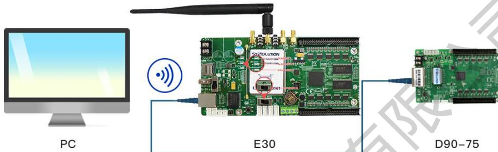
2-1 图：硬件连接示意图
