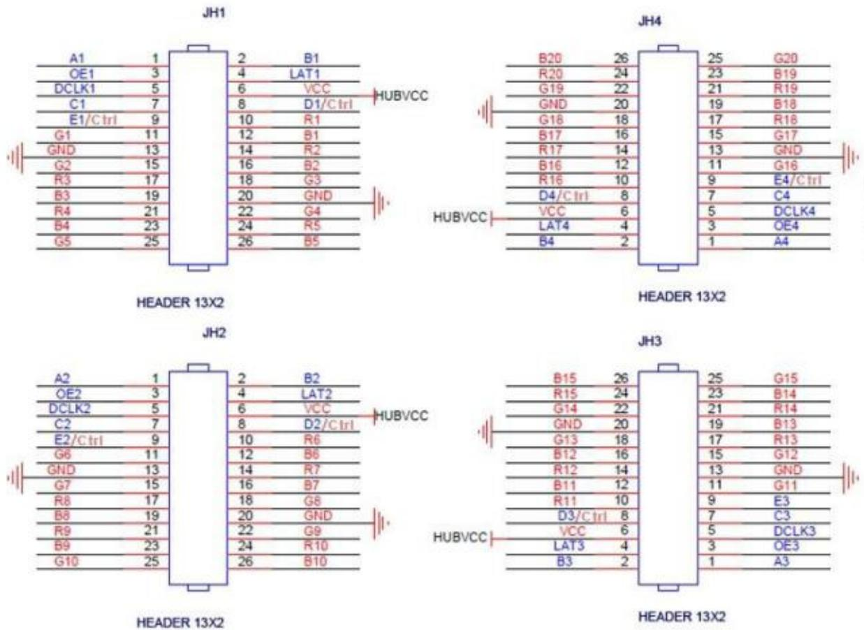
16 扫以下 (含 16 扫) Pin9 为 Ctrl, 8 扫及以下, Pin8 自动输出 Ctrl 信号。
