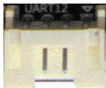
1. 此串口可通过硬件调整,配置为 RS232 的形式与外部设备进行数据连接。
