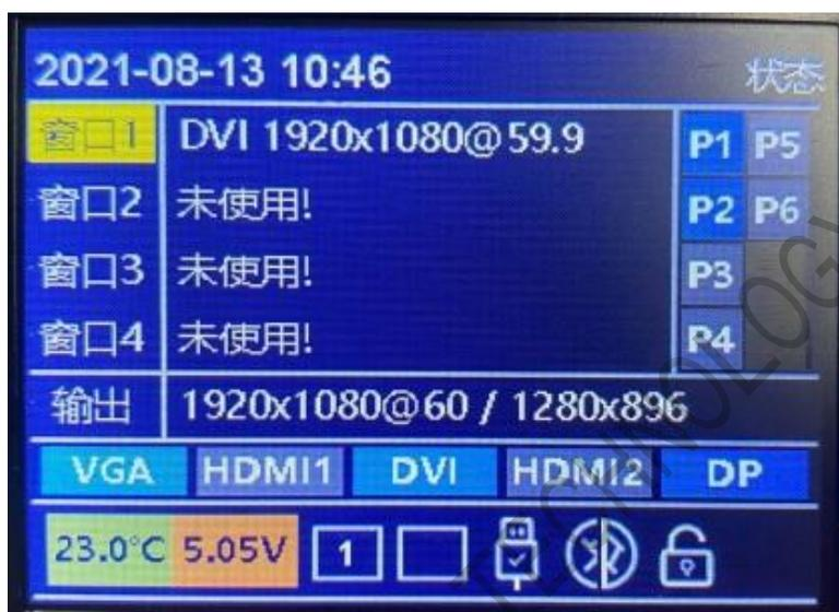
精确显示我们前端输入过来的信号源分辨率、各个窗口信息、网口连接状态、按键锁状态、USB 调试线连接状态等信息。
