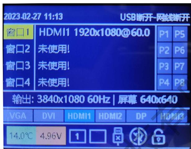
精确显示我们前端输入过来的信号源分辨率、各个窗口信息、网口连接状态、按键锁状态、USB 调试线连接状态等信息。
