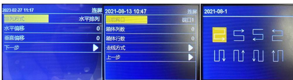
排列方式,选择水平垂直排列,设置水平,垂直偏移, 下一步, 依次设置箱体列数、箱体行数、走线方式, 完成后设置下一网口。
