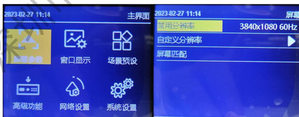
系统预设 18 种输出分辨，见上图。当实际应用在 LED 显示屏上时，我们可以选择比 LED 屏幕分辨率大的预设输出分辨率，也可以设置成刚好 LED 显示屏分辨率大小的输出分辨率。
