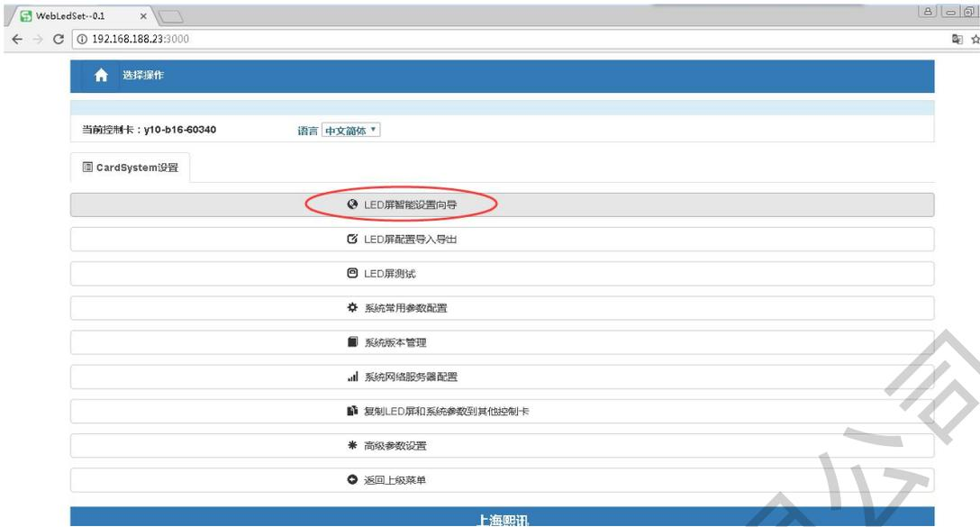
Step 3：进入设置向导会弹出提示框“是否需要重新配置模组”，通常新拿到的控制卡是没有匹配模组参数信息的，选择“是”进入智能设置参数向导，操作如下图：（如果显示屏已经正常显示不需要重新智能设置则可以选择“否”直接进入下一项“级联参数设置”）
